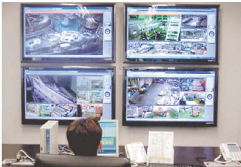
工場内に設置したカメラの映像で集中監視できるシステム
