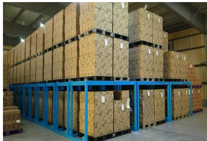
榛東倉庫「簡易ラック」
